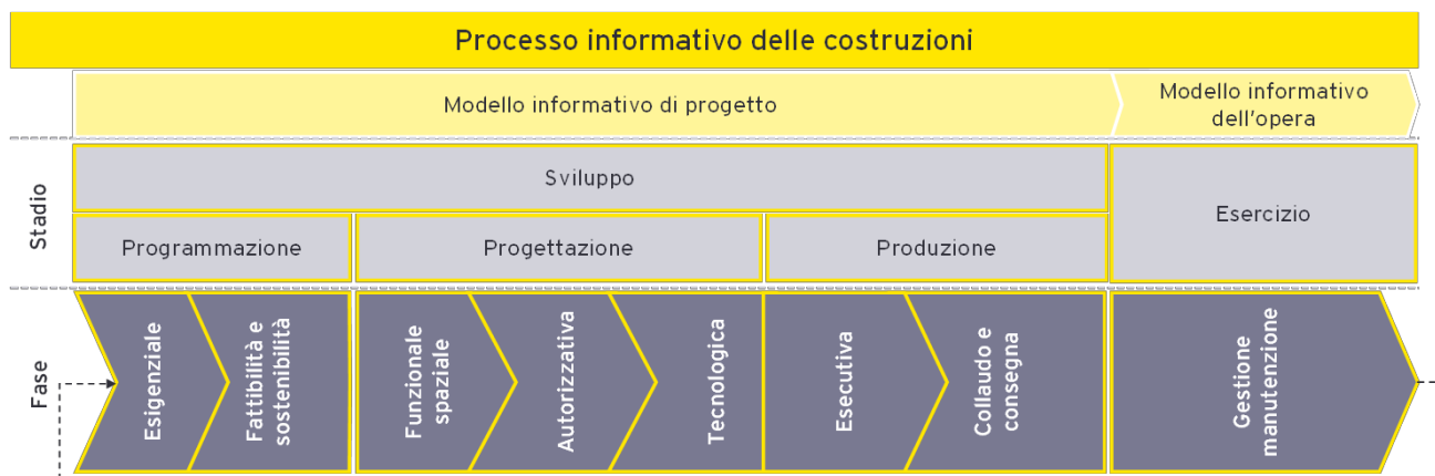
Figura 1 - Processo informativo delle costruzioni
