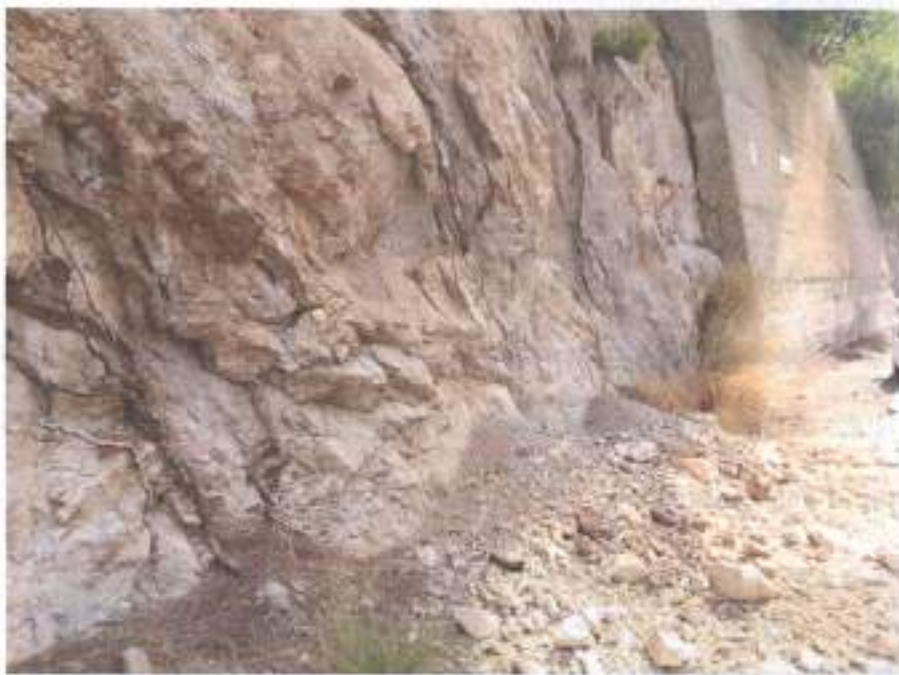
(foto 4) Risultato della scarsa coesione della struttura brecciata della formazione rocciosa interessata da processi di dolomitizzazione
