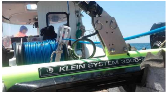
Fig. 3.5.3 Sistema SSS Klein 3900 dotato di verricello elettrico
