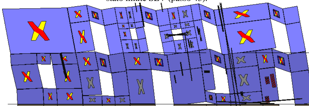
Analisi "Pushover +X Acc". Configurazione della parete 3 in corrispondenza della capacità relativa allo stato limite SLV (passo 46).
