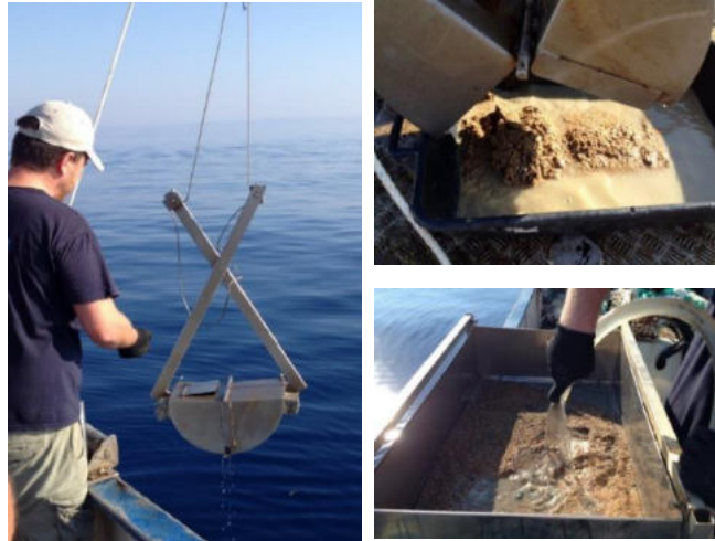
Fig. 3.5.6 Recupero della benna Van Veen e setacciatura sedimenti su maglie di 1 mm
