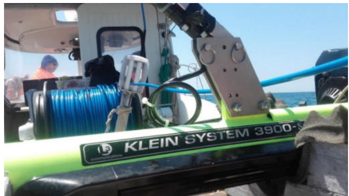
Fig. 3.5.4 Sistema SSS Klein 3900 dotato di verricello elettrico
