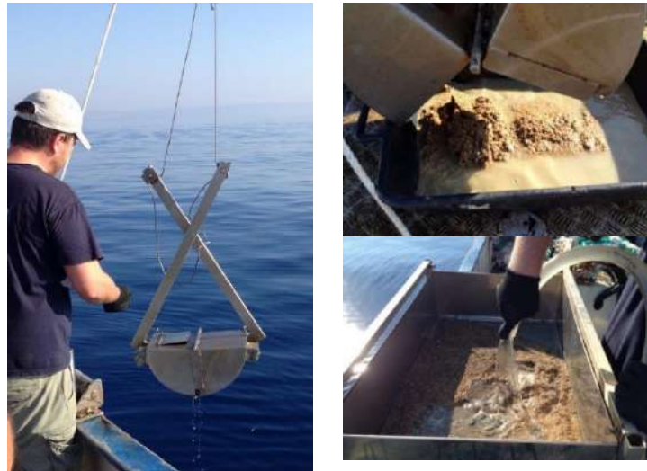
Fig. 3.5.5 Recupero della benna Van Veen e setacciatura sedimenti su maglie di 1 mm
