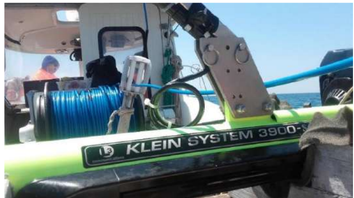
Fig. 3.5.3 Sistema SSS Klein 3900 dotato di verricello elettrico
