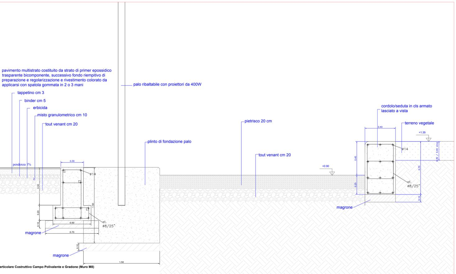
Particolare Costruttivo Campo Polivalente e Gradone (Muro M8)
