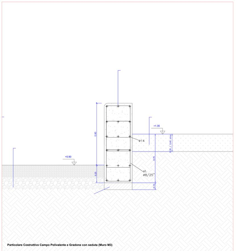
Particolare Costruttivo Campo Polivalente e Gradone con seduta (Muro M3)
